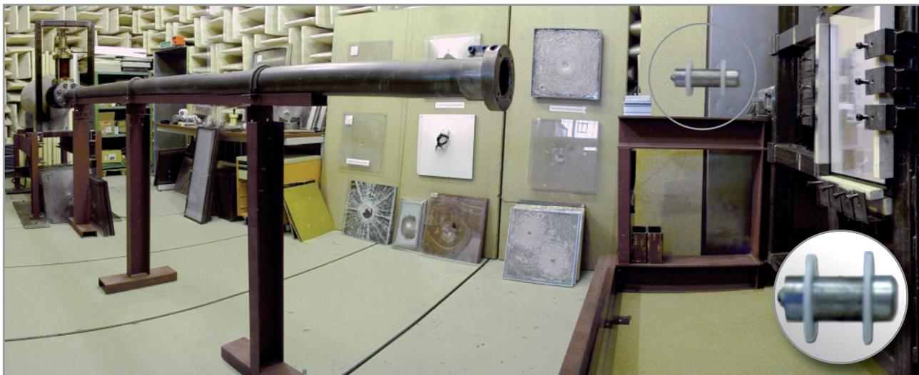
Vista panoramica del laboratorio dove sono stati effettuati i test (IWF della TU di Berlino). In primo piano, il cannone con il proiettile (ingrandito).
