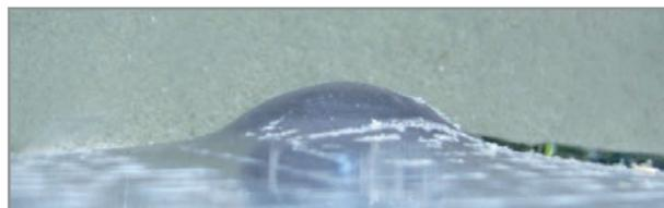
Deformazione corretta del policarbonato dopo l'impatto con il proiettile
