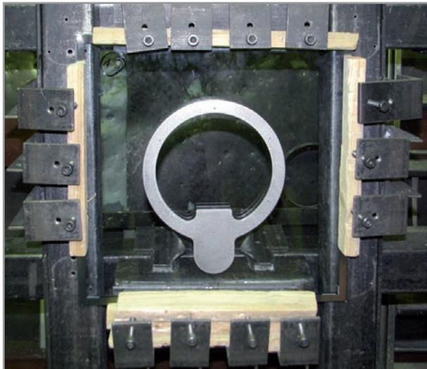
Sistema di fissaggio del pannello di prova con piastra di base
